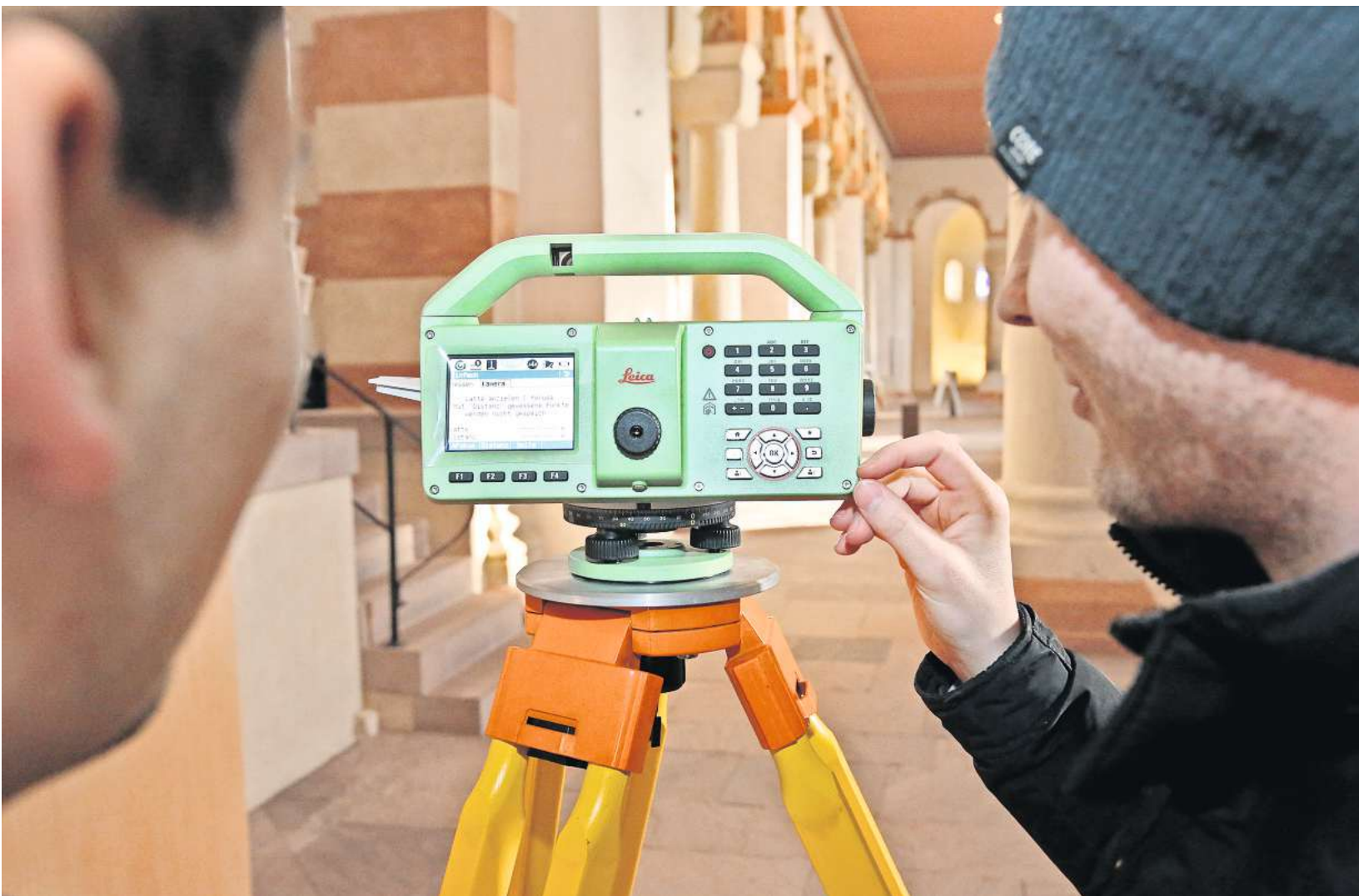
Beim großen Monitoring in der Michaeliskirche werden nicht nur mögliche Setzungen der Kirche geodätisch gemessen, auch das Klima haben Sensoren und Kamera zum Schutz von Bilderdecke, Engelschorschranken und Orgel fest im Visier. FOTOS: MORAS
