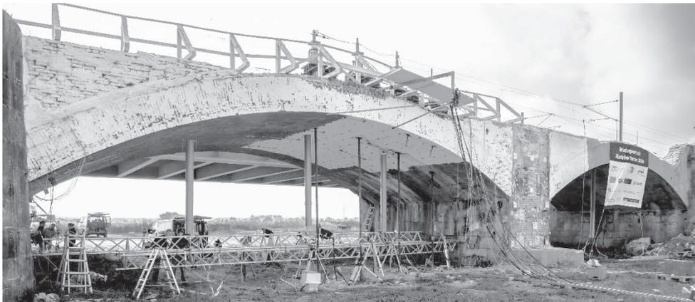
**Abb. 1:** Blick von Westen auf den Bogen 4 der historischen Gewölbebrücke über die Aller bei Verden im Rahmen von V2 im Juni 2016. Der geweißte Bereich an der Gewölbeunterseite kennzeichnet den Bereich im unmittelbaren Einfluss der Lasteinleitung. Im Vordergrund: Messbasis für die Bestimmung der Vertikalverformungen an drei diskreten Stellen. Auf der Brücke: vier Hydraulikzylinder zur Lastaufbringung.
