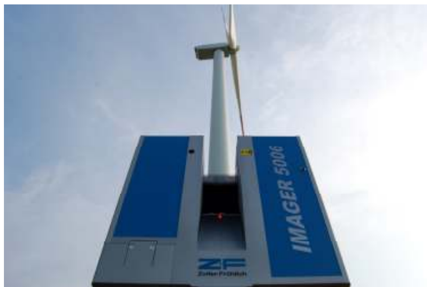
Abbildung 6: Z+F Imager 5006 Scanner während der Aufnahme des Turms einer Windenergieanlage
