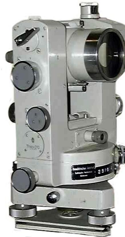
Objektivöffnung 53 mm, Fernrohrvergrößerung 31x
