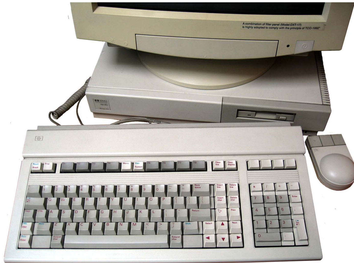
HP 425e Apollo Motorola 68040 Prozessor (25 MHz) Pizza-Box Design, Betriebssystem HP-UX 8.0 Markteinführung 1991
