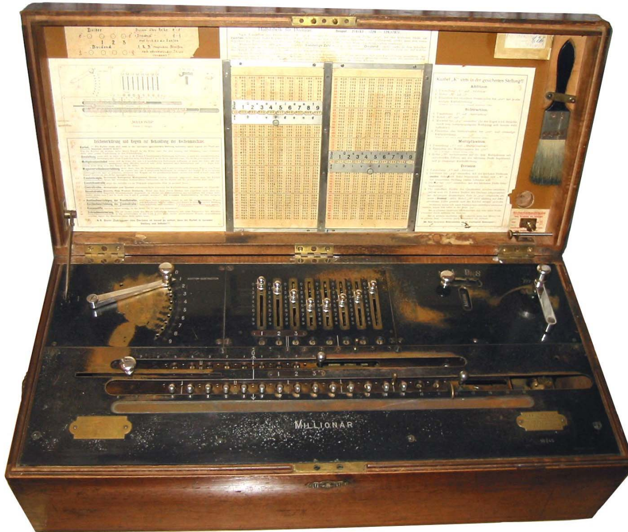
Direktmultiplikationsmaschine Millionär nach Egli & Steiger Nr. 245
