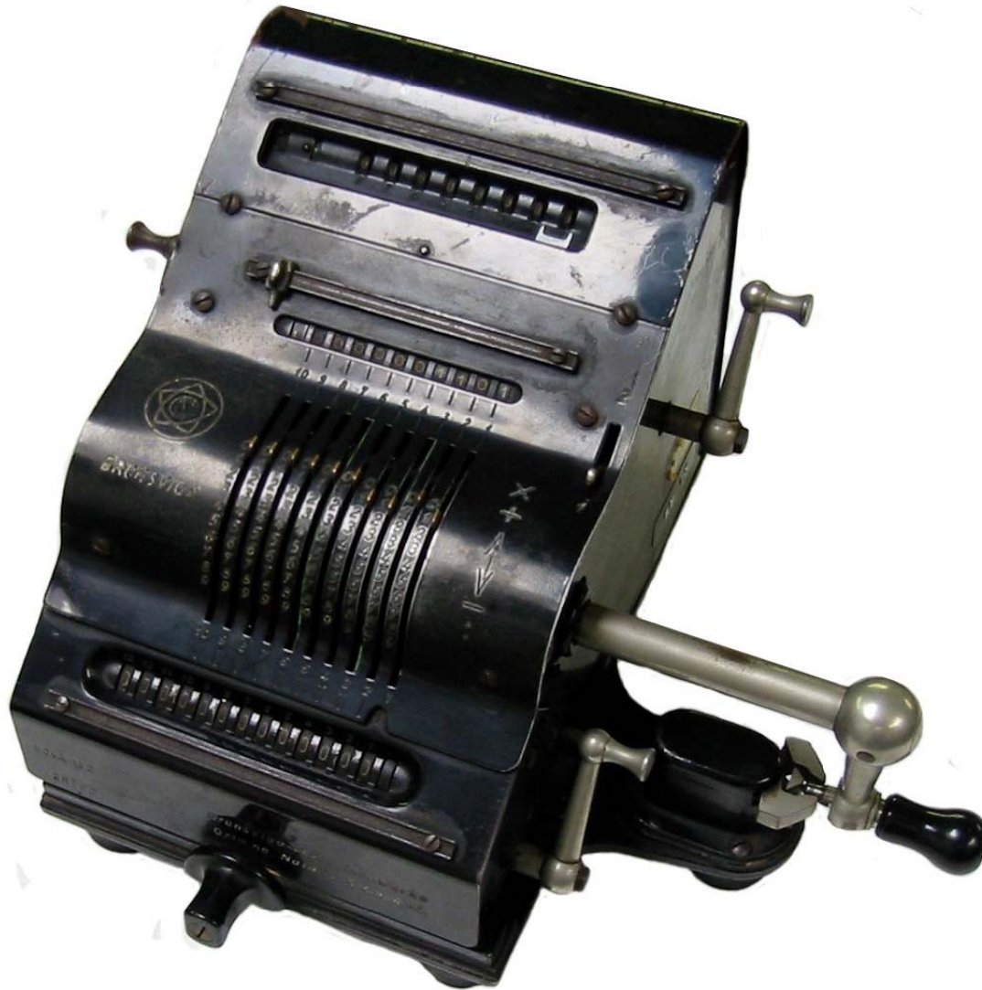
Brunsviga Nova 13 Z, Vierspeziesmaschine, Stellenzahl 10x8x13, Gewicht 7 kg, ab 1932, Nr. 126760
