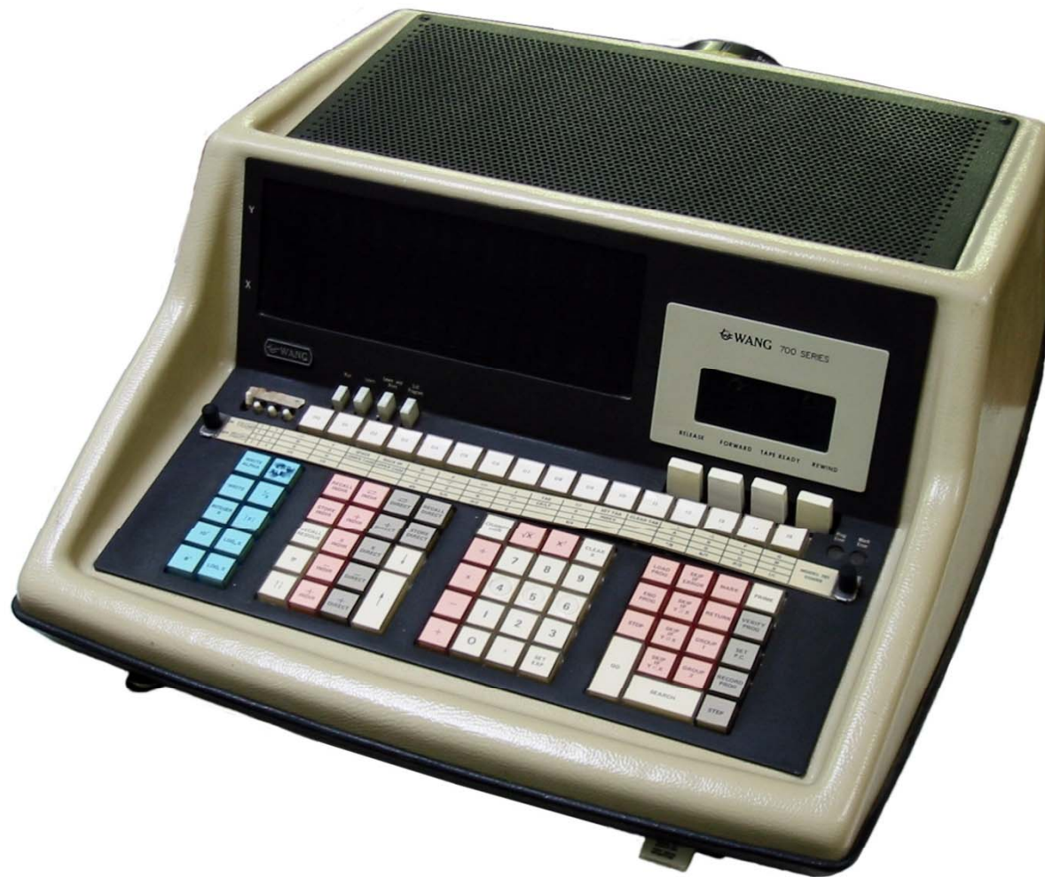
Wang 700 TTL-Technik, Magnetkernspeicher 1 KB RAM, Nixieröhrenanzeige, Kassette, Markteinführung 1971
