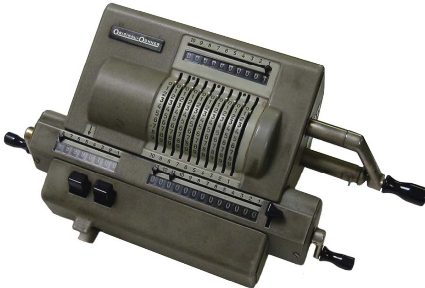
Odhner Modell 239 Vierspeziesmaschine, ab 1955, Nr. 239-883966
