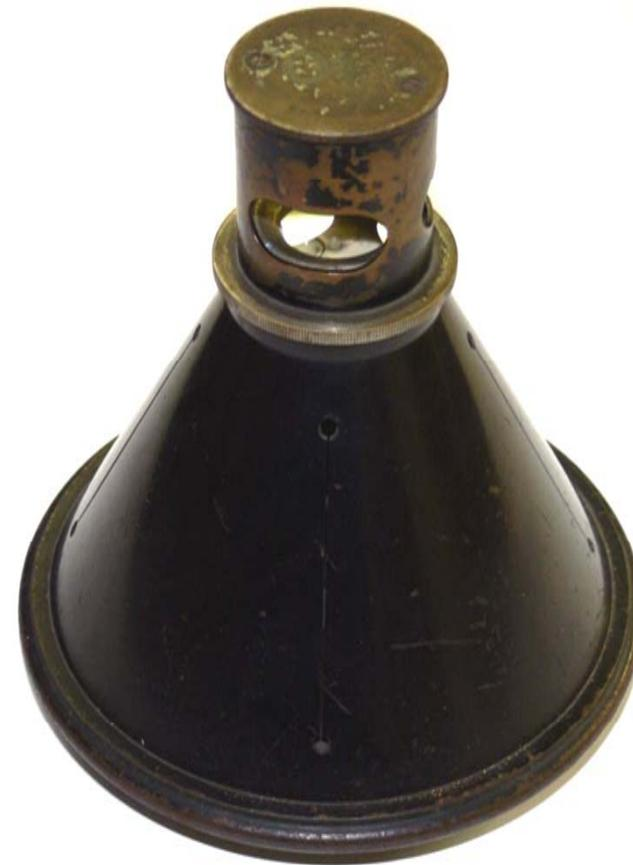
Instrument zum Abstecken rechter Winkel mit Dosenlibelle bzw. Prisma, vorwiegend in Süddeutschland verwendet, da bei gleicher Höhe steilere Visur als bei zylindrischer Bauart möglich.
