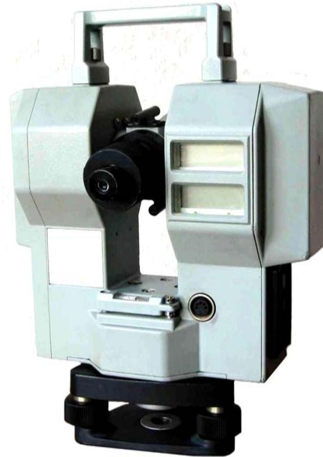
IR-Ga-As-Diode 910 nm, Hauptmodulationsfrequenz 15 Mhz
