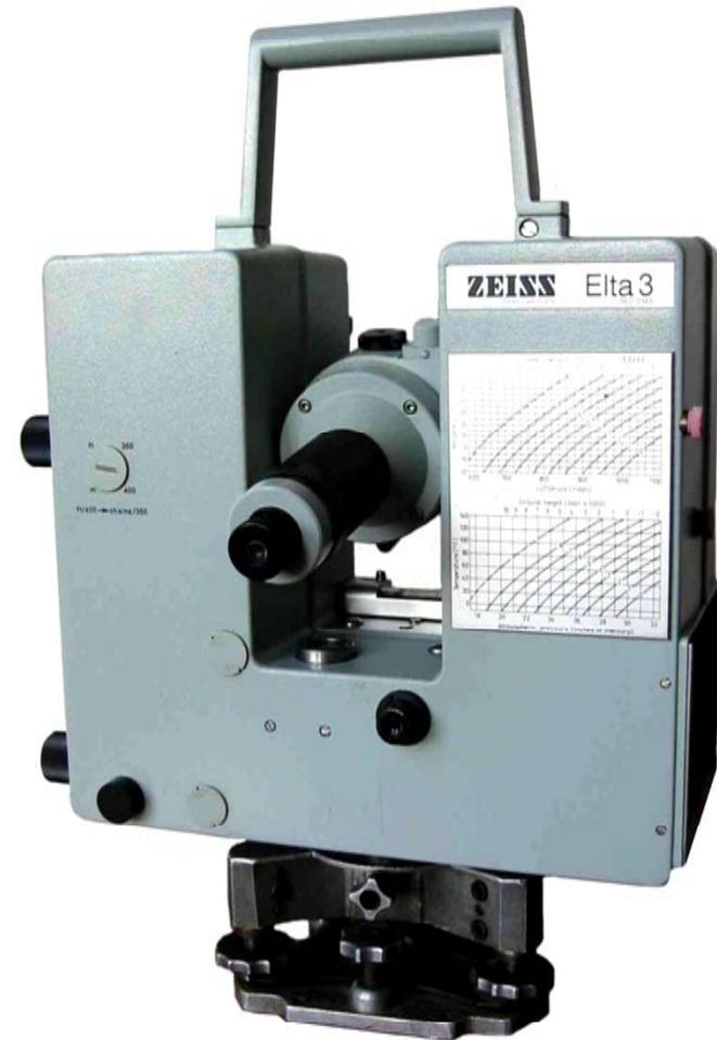
IR-Ga-As-Diode 910 nm, Hauptmodulationsfrequenz 15 Mhz
