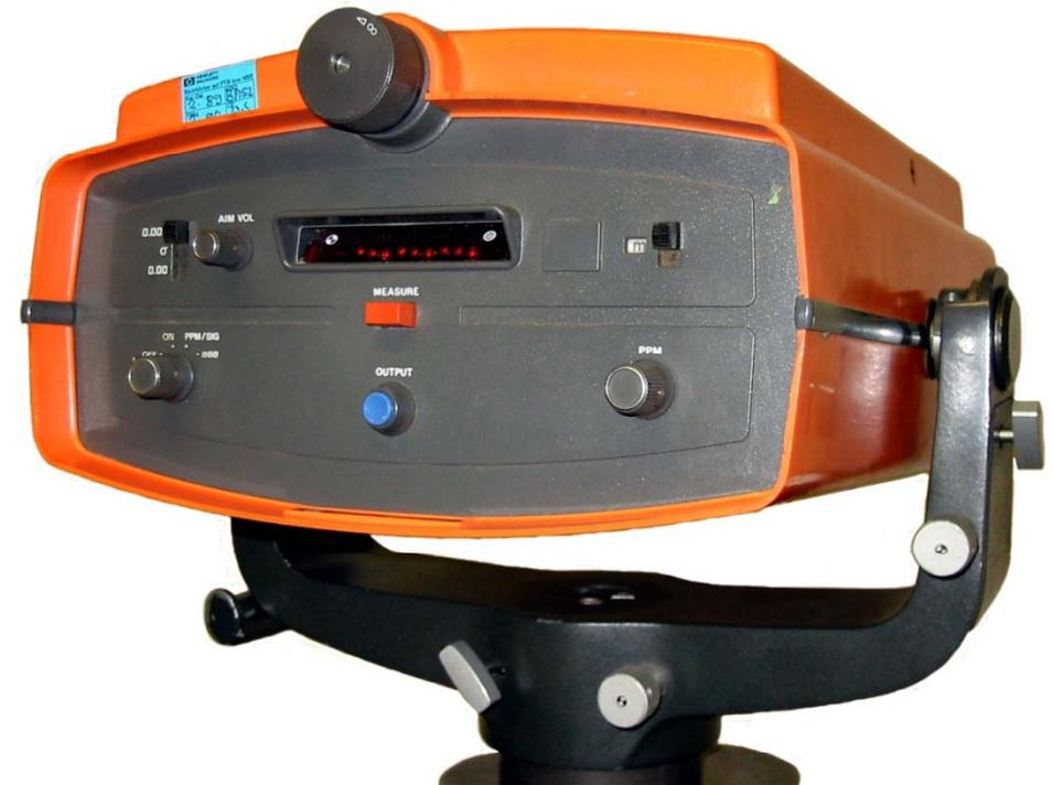
IR-GaAs-Diode 910 nm
