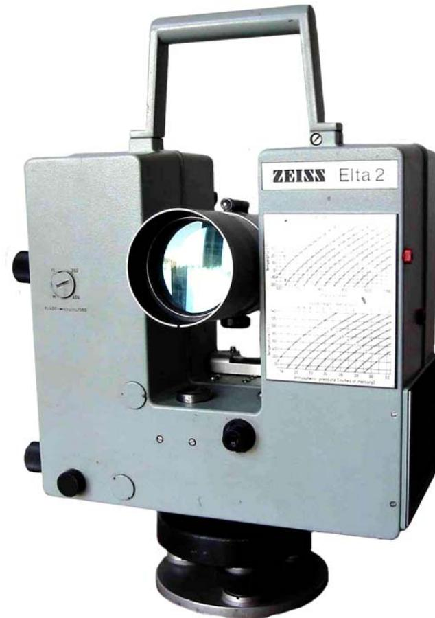
IR-Ga-As-Diode 910 nm, Hauptmodulationsfrequenz 15 Mhz
