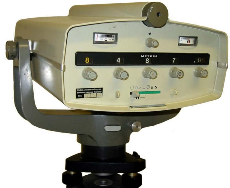
IR-GaAs-Diode 910 nm
