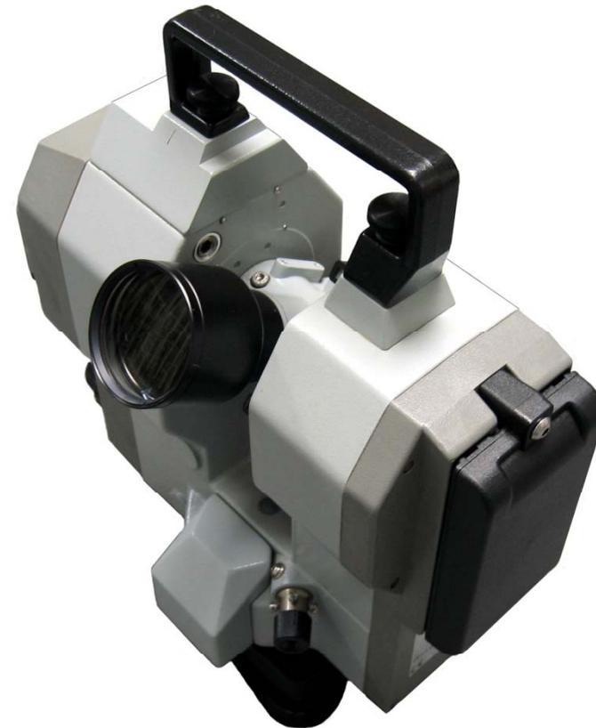
Motorisiertes elektronisches Tachymeter
