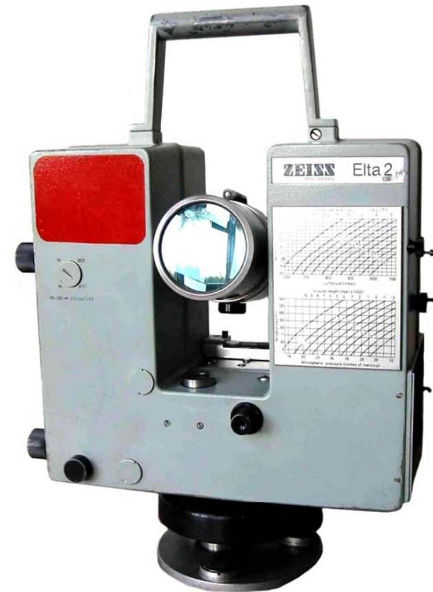
IR-Ga-As-Diode 910 nm, Hauptmodulationsfrequenz 15 Mhz
